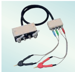
4端子探头L2000 DC~5MHz 特性阻抗50Ω 4端子结构 可测端口直径: 5mm以下 ※线长1m
