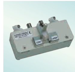
SMD测试治具9699 适用于底部有电极的SMD DC~120MHz 样品尺寸: 宽1.0~4.0mm, 高1.5mm以下
